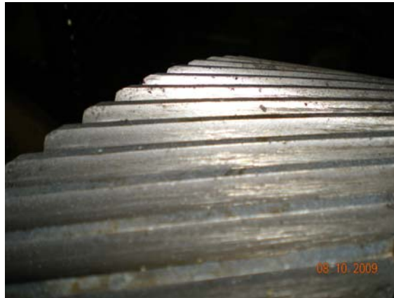
Рис. 2 - Стирання (абразивне зношування) контактуючих поверхонь.
