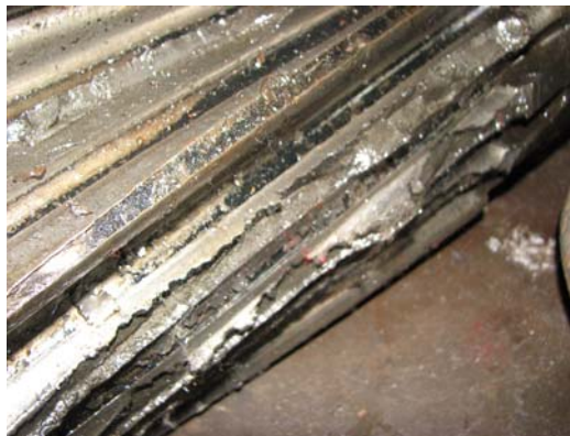
Рис. 3 - Виламування (локальне зношування) контактуючих поверхонь.
