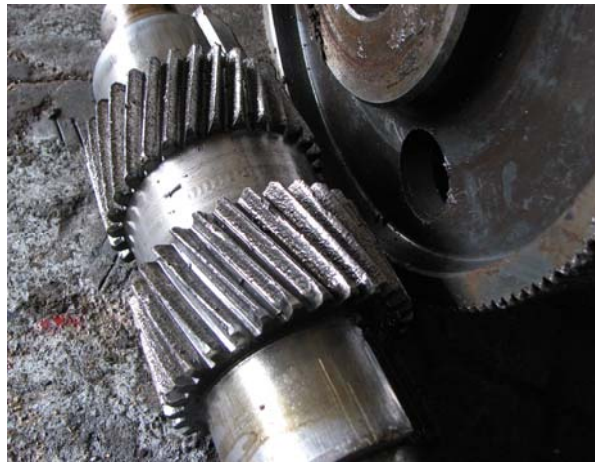
Рис.6 - Задир (заїдання) контактуючих поверхонь редуктора.
