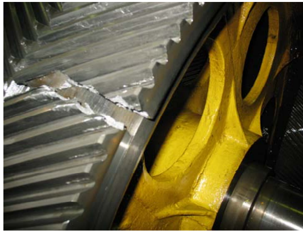
Рис. 5 - Розвиток тріщини в зубчастому колесі редуктора.
