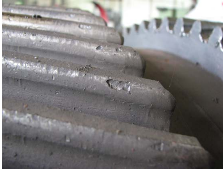
Рис. 4 - Раковина в зоні контакту контактуючих поверхонь.
